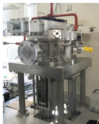
レーザー照射式グラフェン成膜装置
